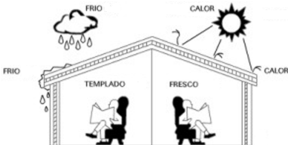
Fig. N° 17 _ Diferencial de temperaturas con la ayuda de aislante térmico.
