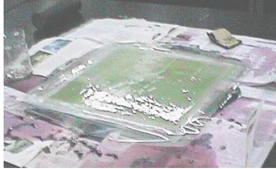
Figura 3-11 Conjunto de fibra impregnado de resina
