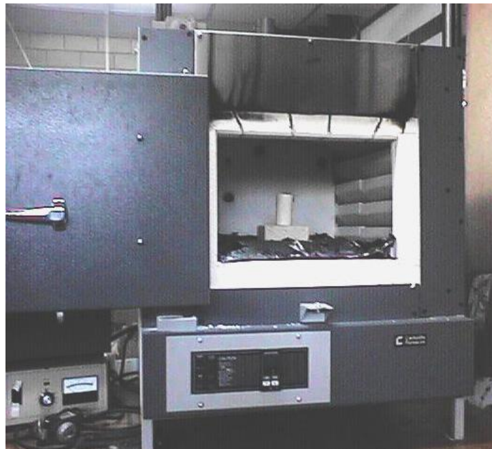
Figura 3-36 Calentamiento de compuesto en horno
