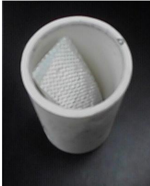
Figura 3-37 Crisol con fibra después de que la resina se ha consumido
