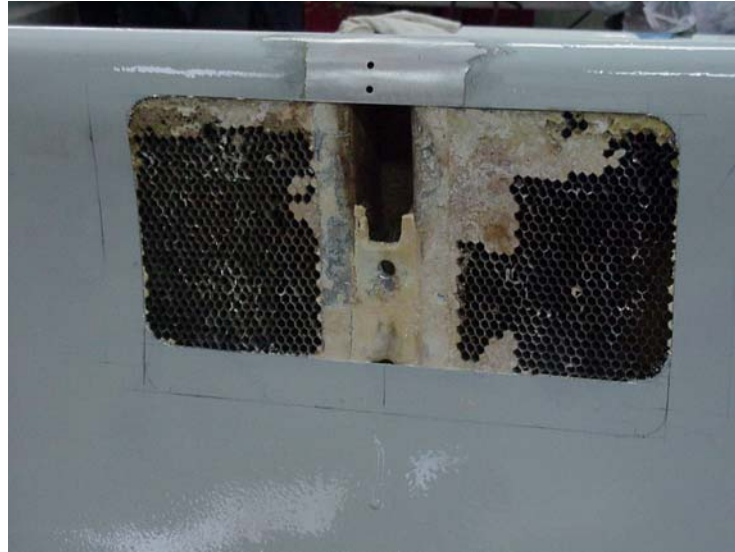
Figura 1-7 Superficie de control que presenta núcleo de sandwich en panal de abeja de aluminio y cubiertas en aluminio.
