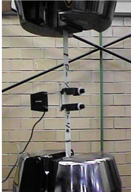
Figura 3-47 Probeta con extensómetro, colocada en máquina de pruebas.
