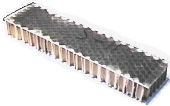
Figura 3-49 (b) Fotografía de la probeta empleada para ensayos de flexión
