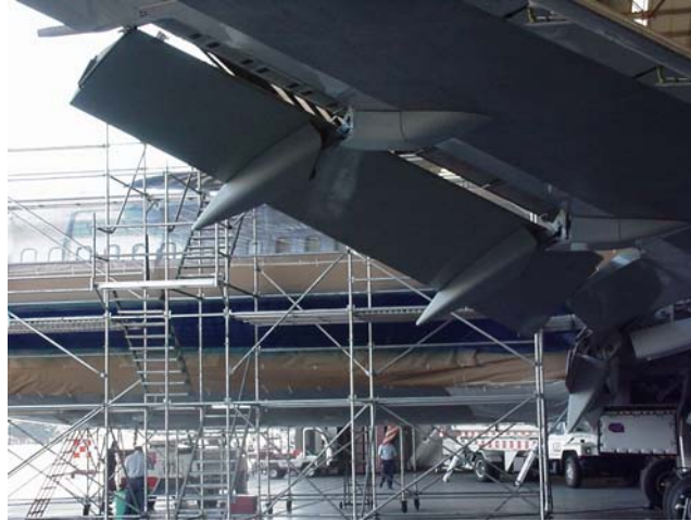
Figura 1-5 Aletas hipersustentadoras (Flaps) en un avión B 767 fabricadas en material compuesto tipo sandwich
