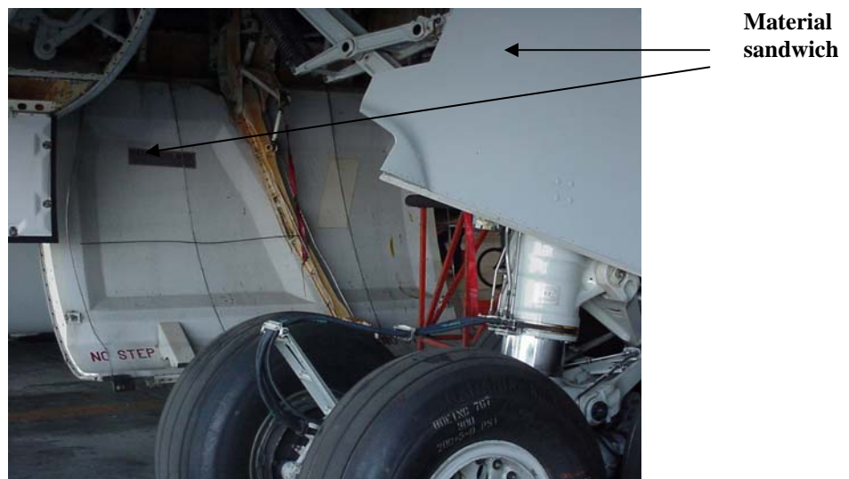
Figura 1-6 Compuertas del pozo del tren de aterrizaje principal del avión B - 767
