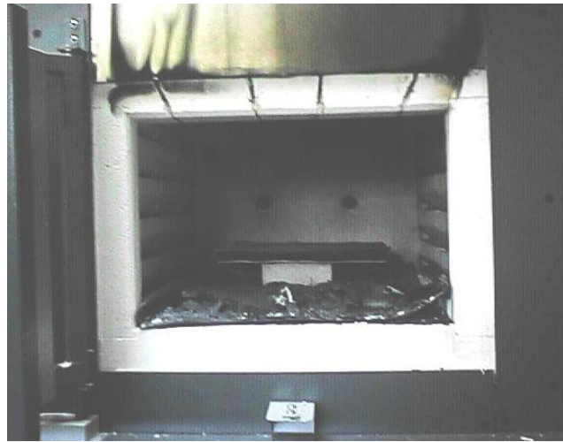
Figura 3-8 Eliminación del recubrimiento del refuerzo
