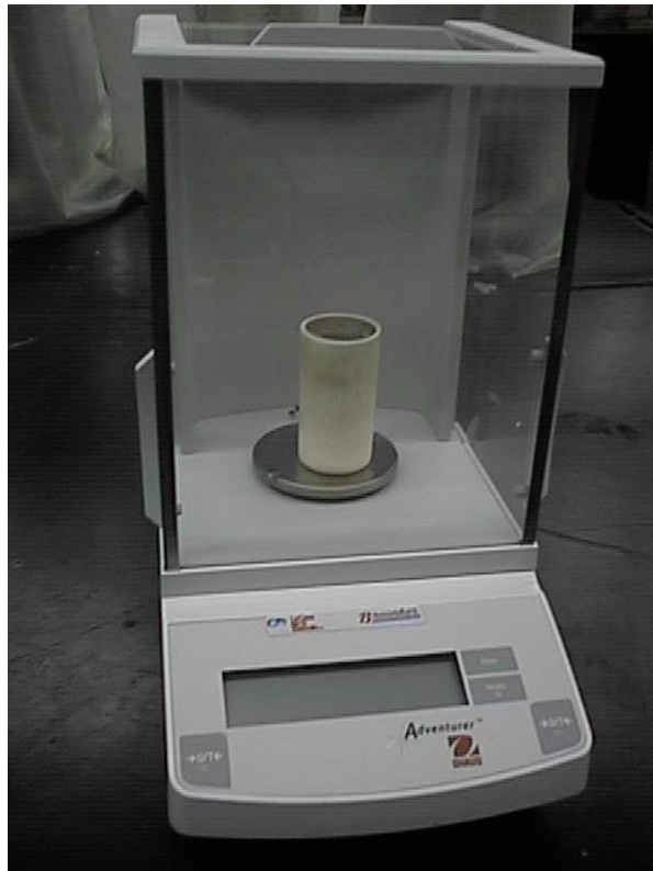
Figura 3-35 Medición de masa de crisol y probeta
