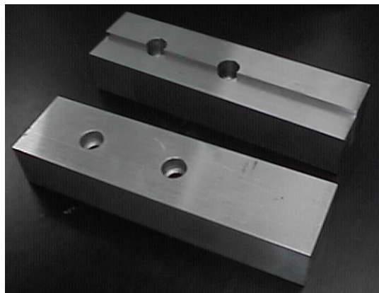
Figura 3-20 Soportes para corte de laminado
