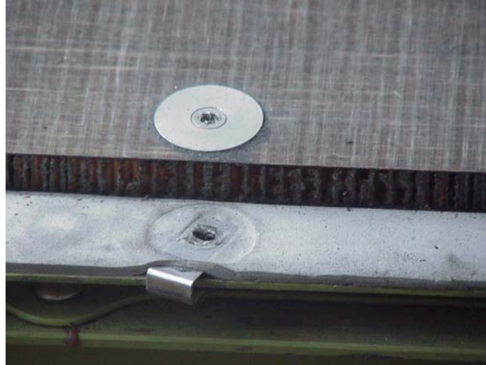
Figura 1-3 Detalle del piso de la cabina de pasajeros de un avión MD 80.
