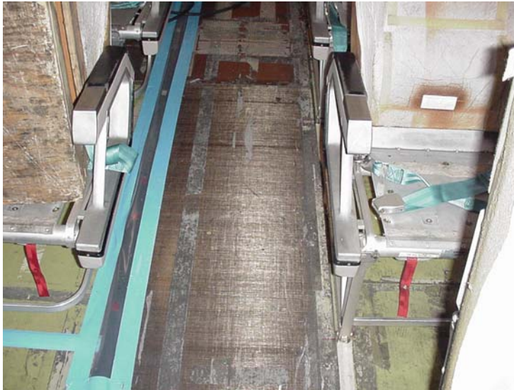
Figura 1-1 Pisos de panel sandwich en avión MD-80
