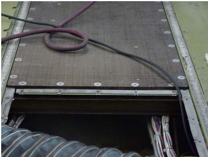
Figura 1-2 Piso de panel sandwich avión MD-80
