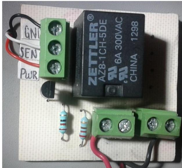
Figura 4.1 “Circuito actuador para lámpara y puerta”
