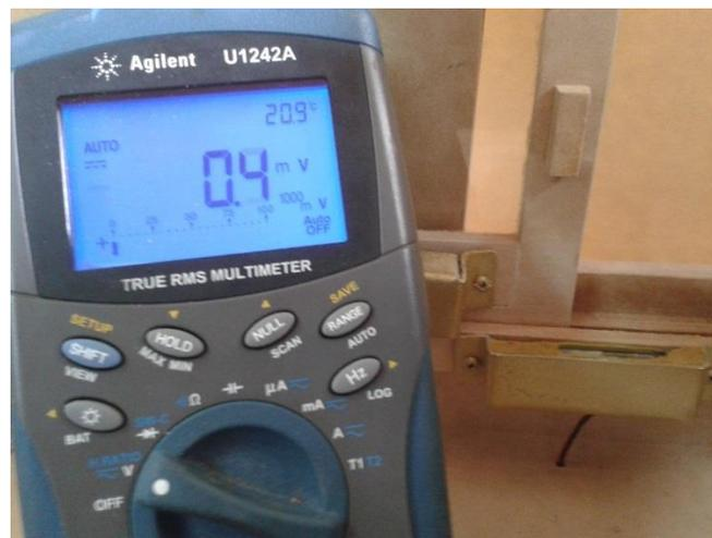
Figura 4.5 “Voltaje de salida con sensor abierto”
