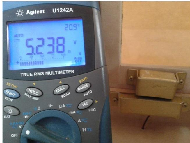
Figura 4.4 “Voltaje de salida con sensor en conducción”
