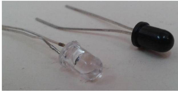
Figura 4.7 “Fototransistores para luz infrarroja (negro) y para luz visible (transparente)”
