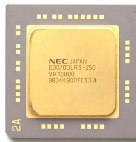
Fig. 2.1 Procesador R10000 fabricado por NEC Corporation
