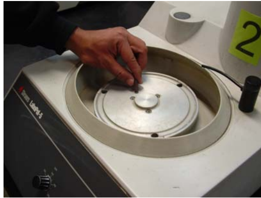
Figura II.10. Pulido del material.
