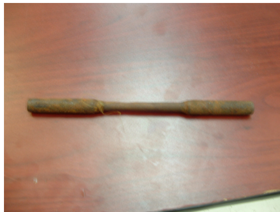
Figura 2.11. Acero estructural A36 expuesto durante un año
