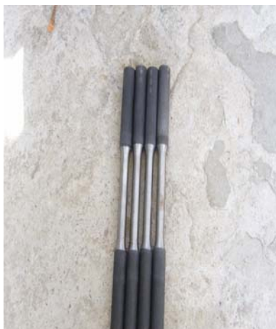
Figura II.4. Acero estructural A36 virgen. Figura II.5. Acero estructural expuesto a seis meses.
