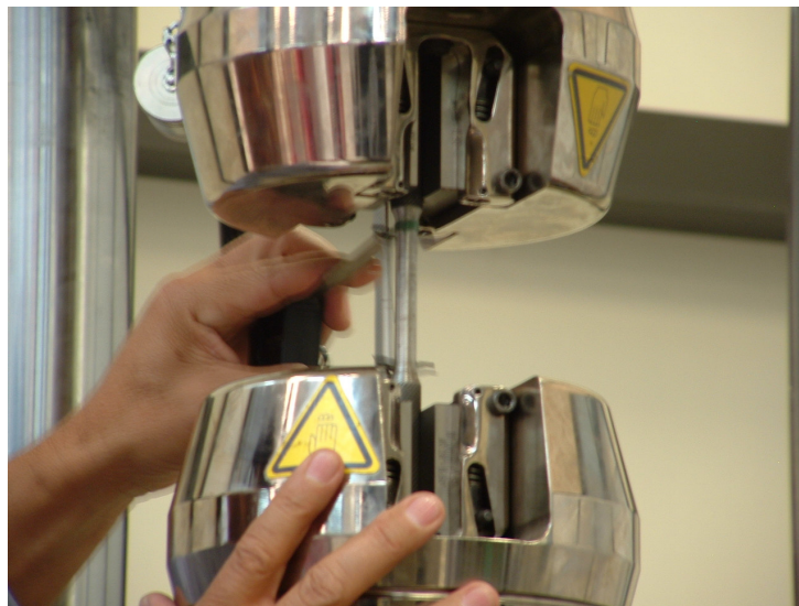
Figura 2.3. Colocación del extensómetro.
