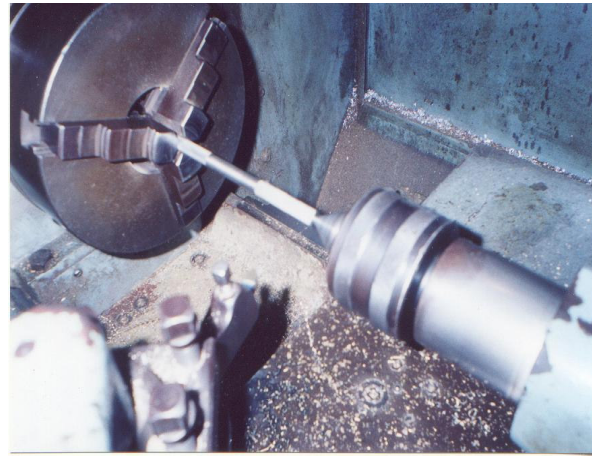
Figura 1.3. Finalización de moleteado.
