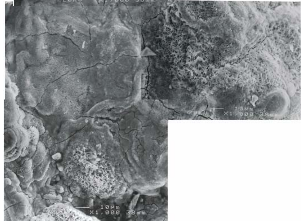
Figura II.15. Prueba de laboratorio: Acero estructural A36 expuesta durante seis meses en el mar. a) Prueba de ensaye; b) gráfica de carga-deformación; c) corte de la muestra; d) fractografía de una muestra de acero estructural a 1000 aumentos.
