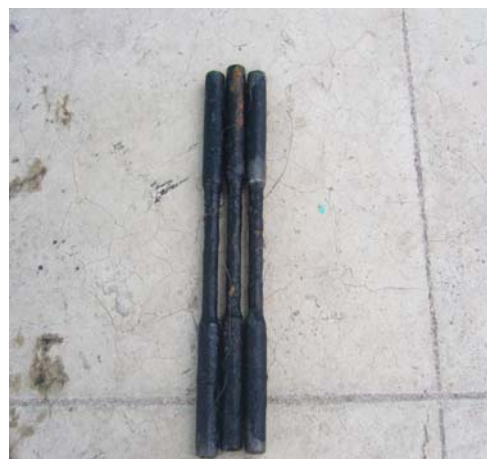
Figura II.4. Acero estructural A36 virgen. Figura II.5. Acero estructural expuesto a seis meses.
