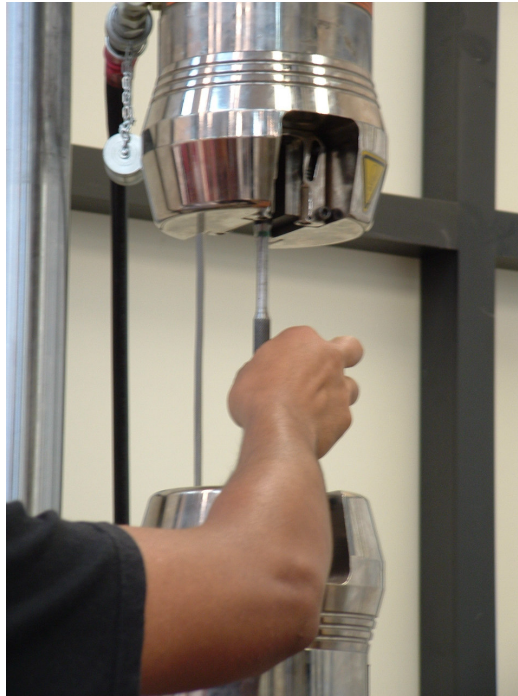
Figura 2.2. Colocación del material.
