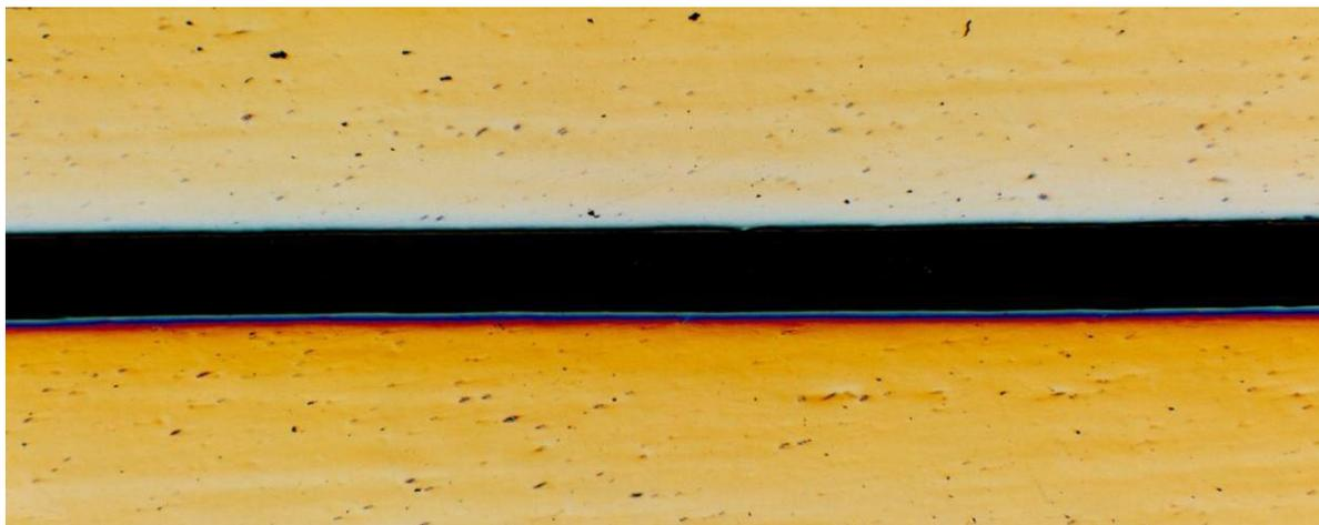
Figura 11. Depósito de latón obtenido con un 96-1% de exceso de NaCN.
