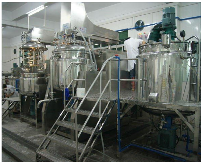
Figura 2.17. Mezclador de emulsión de cosméticos. 21
