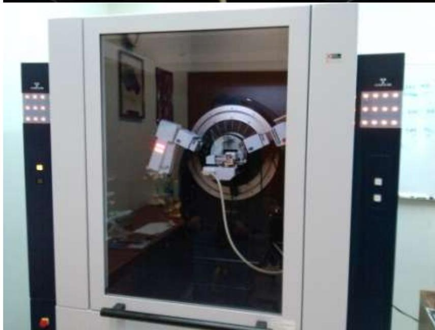
*Figura 2.3. Difractómetro D8 Advance.*
