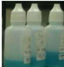
Fig. 2.7. Muestras de soluciones experimentales de la lixiviación de escorias de fundición de cobre.
