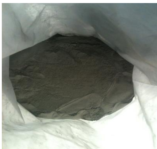
Fig.2.5. Escorias con un tamaño de partícula de 150 \mu\text{m} .
