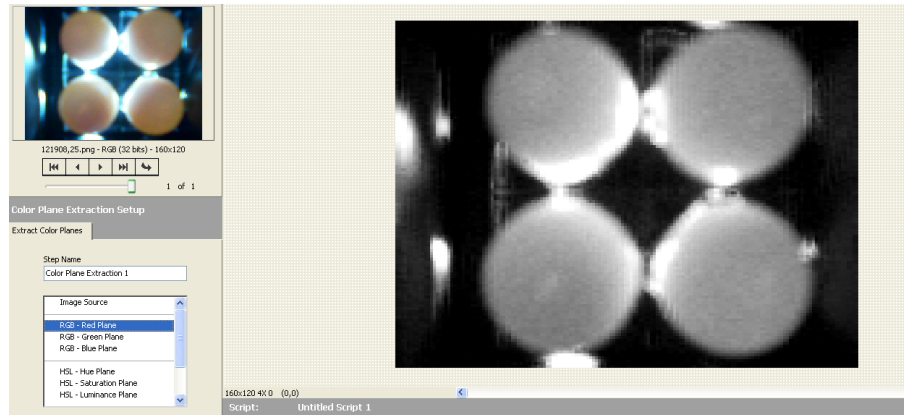
Figura 3.9 Comando de extracción de plano de color a partir de una imagen base en asistente de visión
