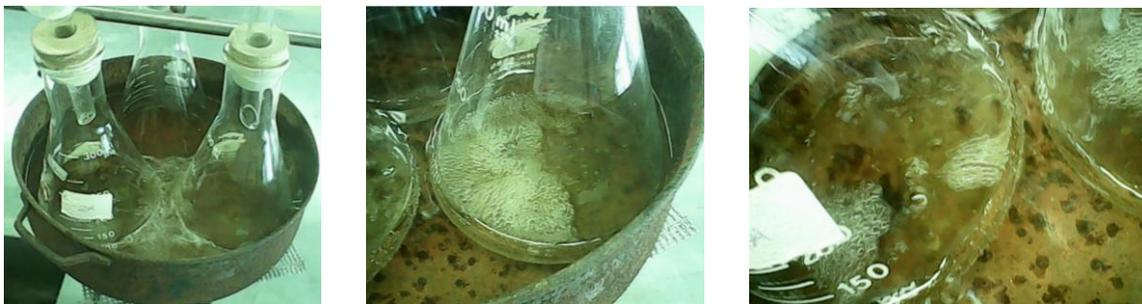
*Figuras 47, 48 y 49. Calentamiento de las muestras y reflujamiento de las mismas.*
