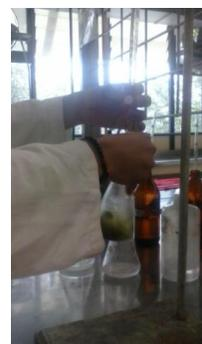
*Figuras 41 y 42. Titulación y obtención del índice de yodo.*
