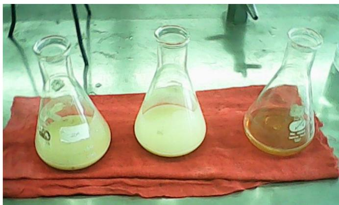
Figura 53. Muestras después de la saponificación.
