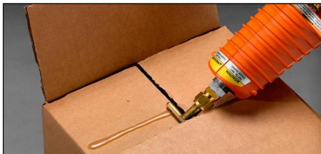
*Fig. 25. Aplicación de un adhesivo termo-fundente.*
