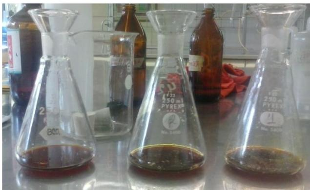
Figura 39. Preparación de muestras para obtención del índice de yodo.
