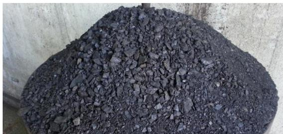
*Fig. 20. Lignito bituminoso.*
