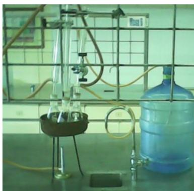
*Figura 46. Montaje de equipo para obtener índice de saponificación.*
