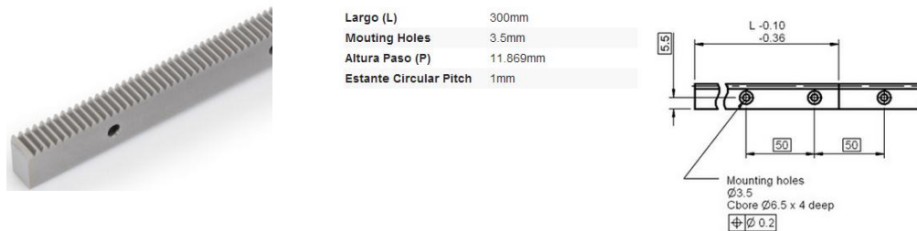
Figura 40. Cremallera módulo 0.3mm
