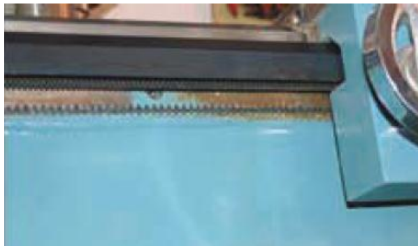
Figura 26. Piñón móvil y cremallera fija
