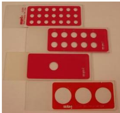
Figura 19. Portaobjetos impresos de diagnóstico PTFE de SPI
