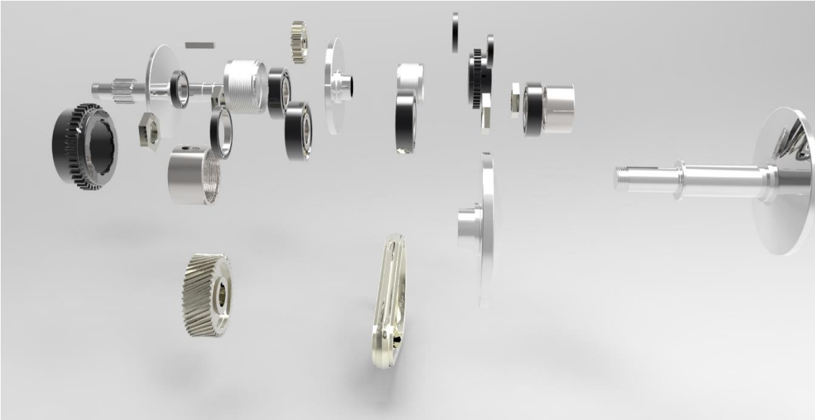
Figura. 75 Vistas de un render que muestra los componentes del sistema CVT
