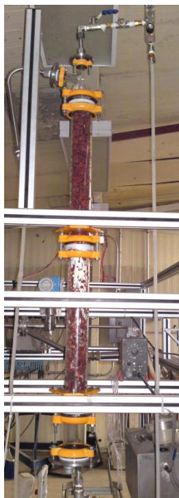
Figura 4.3.2-1 Sistema de Biofiltración 1.9 L.
