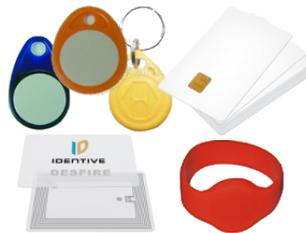
Fig. 2.5. Tipos de Tags NFC-RFID
