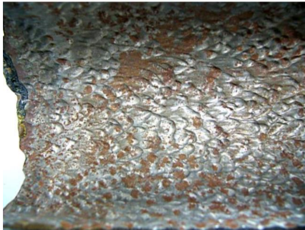
Figura 4. Superficie sometida a FAC en un flujo de una fase.
