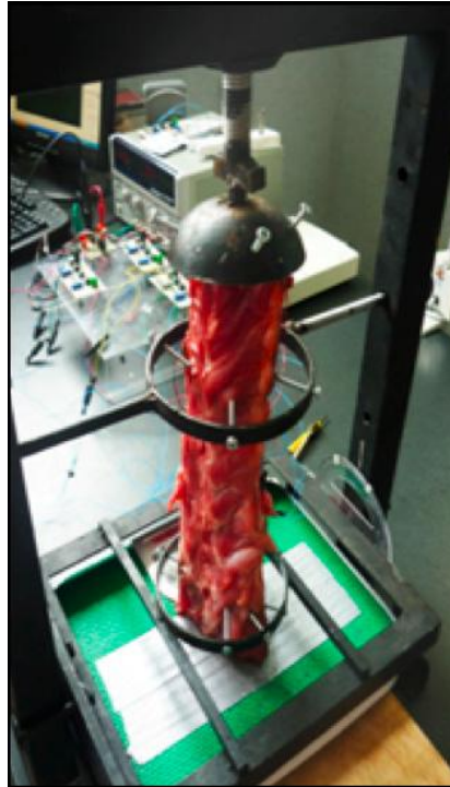
Figura I. 9 Instalación de la mesa de trabajo con la tarjeta adquisidora de señal.
