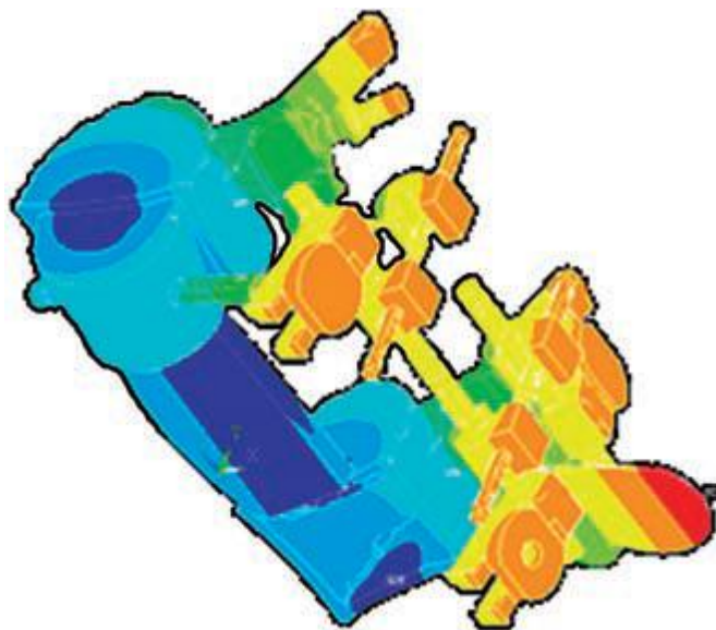
Figura I. 11 Obtención de los esfuerzos generados en las vértebras humanas con corpectomía total en L3, montadas en el fijador interno, mediante la simulación por el método de elemento finito (MEF).
