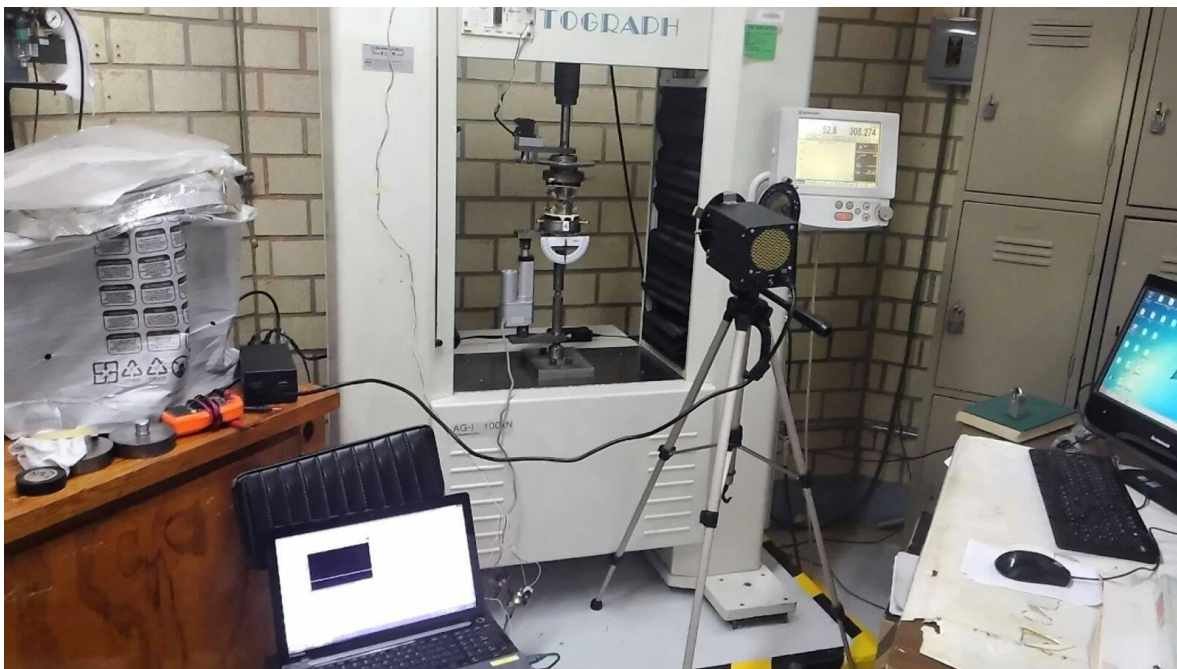
Figura V. 13 Montaje de simulador con especímenes en la máquina universal Shimadzu®.
