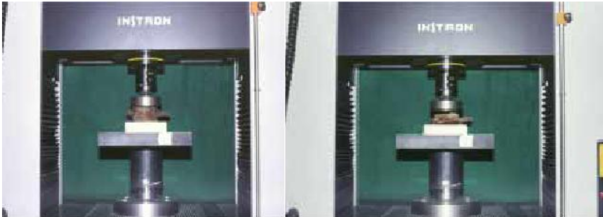
Figura I. 3 Medición de la resistencia y elasticidad en las vértebras de porcino y cadáver.
