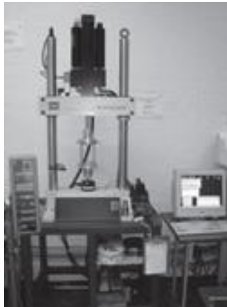
Figura I. 5 Máquina universal MTS con espécimen montado.
