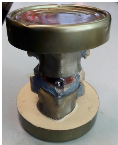
Figura V. 12 Sujeción de la unidad vertebral L4-L5 en las bases.
