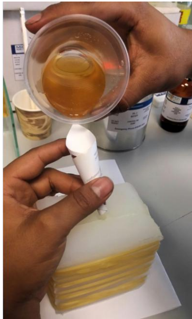
Figura V. 5 Vaciado de resina mezclada en los moldes.
