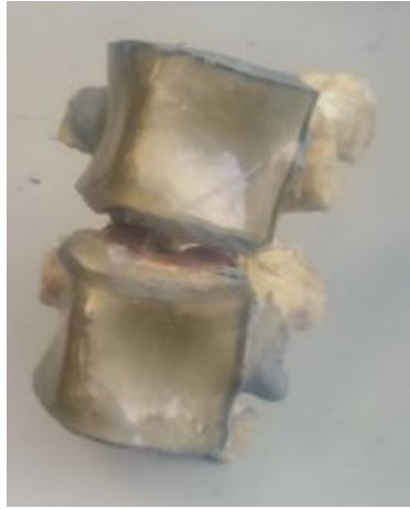
Figura V. 11 Unidad vertebral L4-L5 con aplicación de resina fotoelástica.
