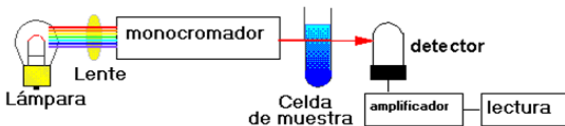
Figura 22. Esquema básico de los instrumentos de un IR.
