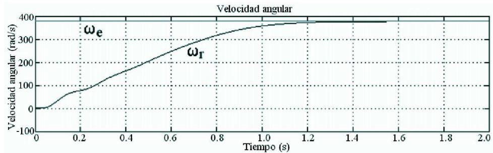
**Fig. 3.4:** Frecuencia angular eléctrica del estator,  $\omega_e$ , y velocidad angular eléctrica del rotor,  $\omega_r$ , en rad/seg.
