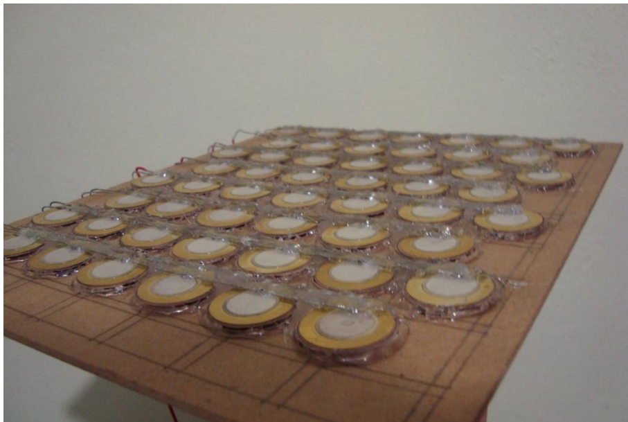
Figura 2.7 Protección mecánica dada a la baldosa mediante la aplicación de silicona.
