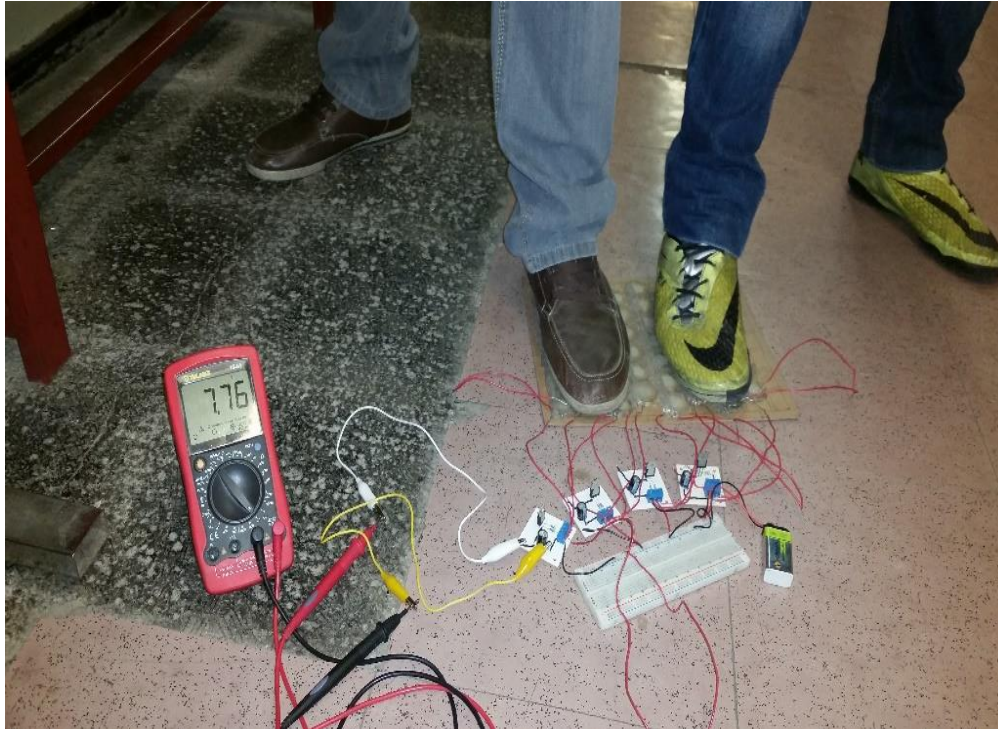
Figura 3.11 Ensayo 3: Factor deformante Mixto 70 y 83 kg a una pierna por factor.
