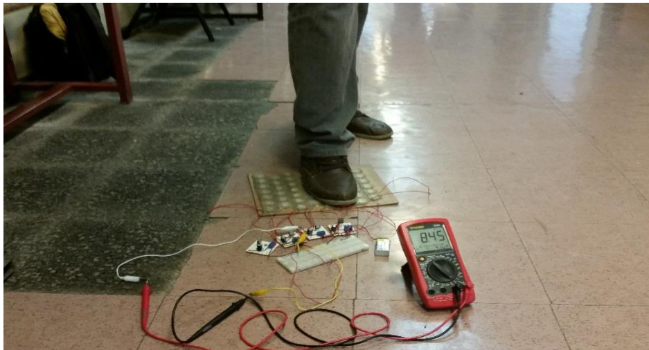
Figura 3.7 Prueba 1: Factor deformante único 83 kg a una sola pierna.
