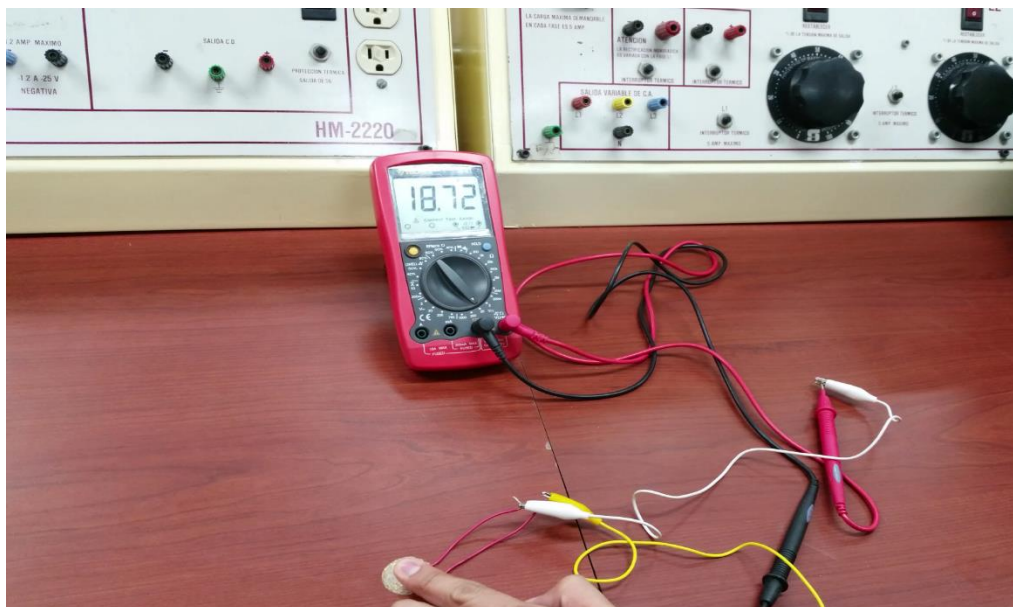
Figura 2.1 Medición de tensión en un disco piezoeléctrico.
