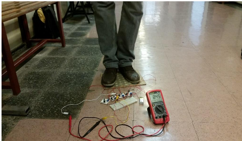
Figura 3.9 Ensayo 2: Factor deformante 70 Kg a dos piernas.
