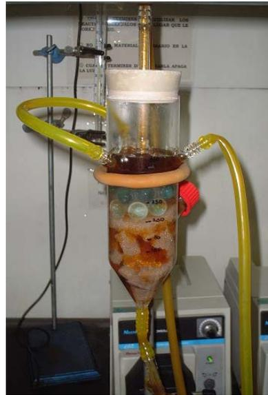
Figura 3. Sistema del reactor de lecho empacado con biomasa inmovilizada
