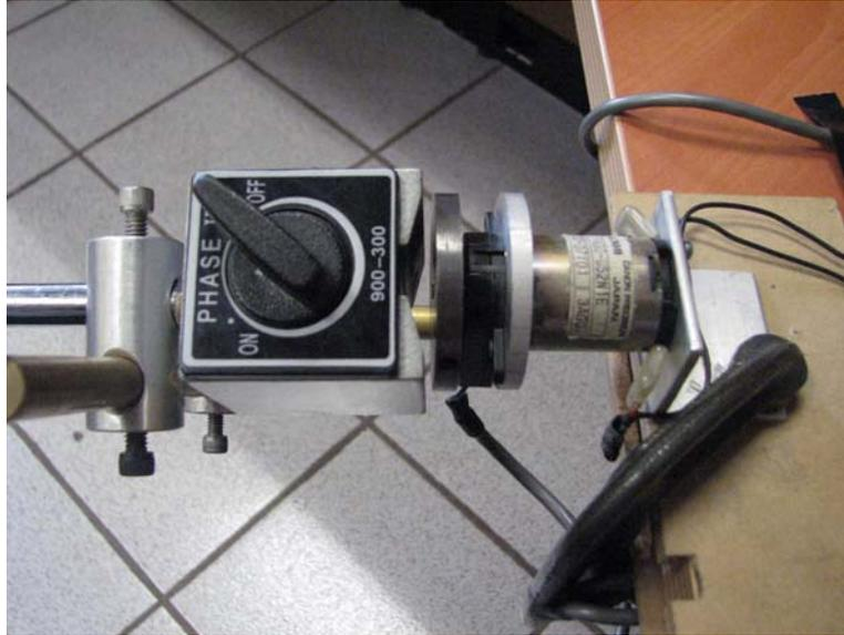
Figura 4-18.- Sistema utilizado para inducir variaciones de carga constantes
