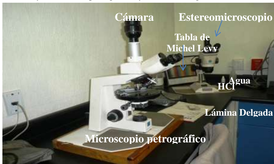
Figura 6. Equipo Petrográfico utilizado para realizar este trabajo. (Laboratorio de Petrografía, CFE).
