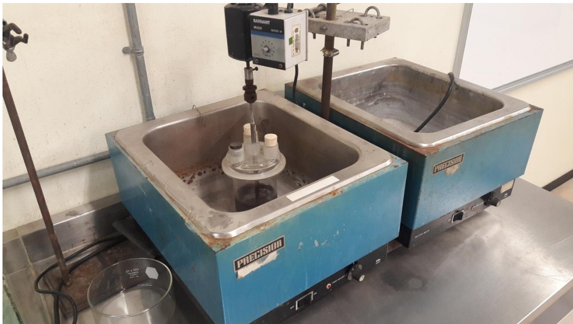
Figura 17. Reactor, moto-reductor y baño isotérmico.
