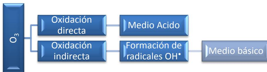
Figura 1. 4. Mecanismo de reacción con ozono en solución acuosa
