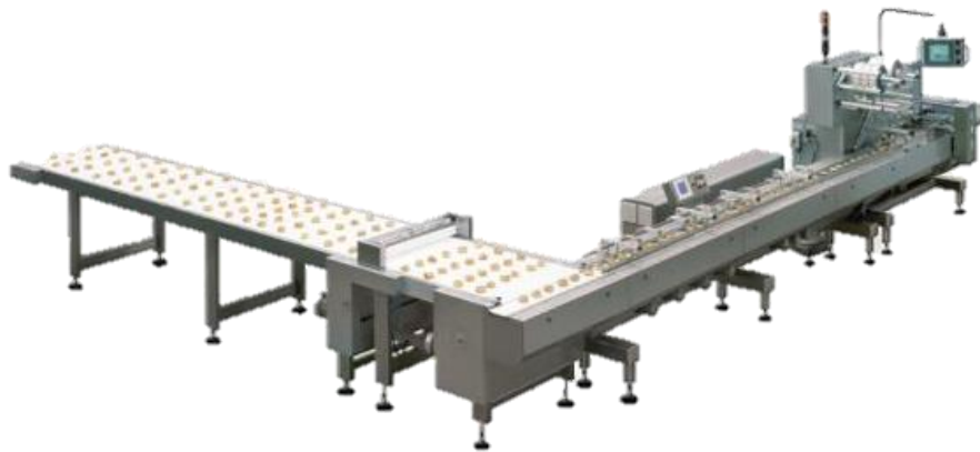
Figura 2-3. Fotografía del sistema de empaque horizontal “Flowangle”[2].
