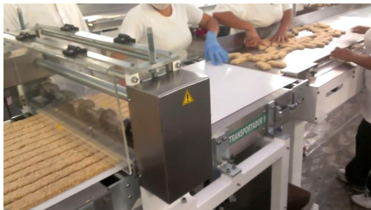
Figura 1-3. Fotografía que muestra a los operarios tomando las barras alimenticias con las manos muy cerca de la cuchilla de corte.
