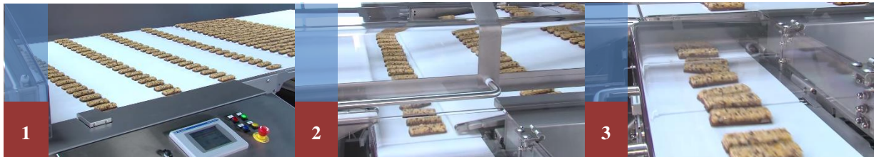
Figura 2-2. Fotografía del proceso de distribución de barras del sistema “Transver SPD[1]”.
