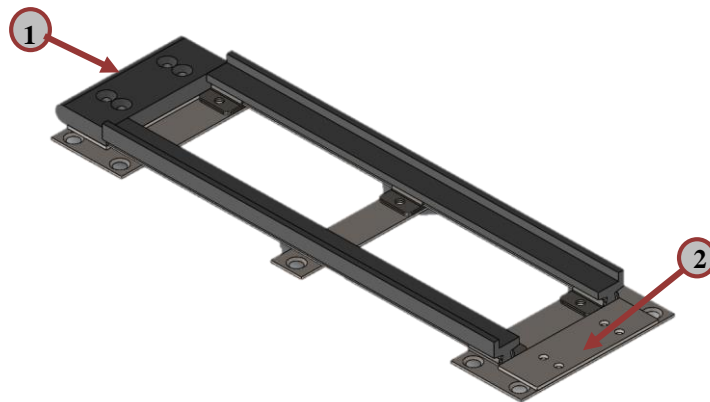
Figura 4-27. Dibujo CAD que muestra las placas de nivelación para fijar barras frontales.
