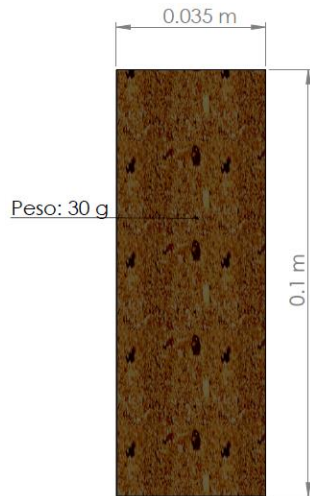
Figura 4-10. Características de la barra alimenticia para determinar la carga del producto sobre la banda.
