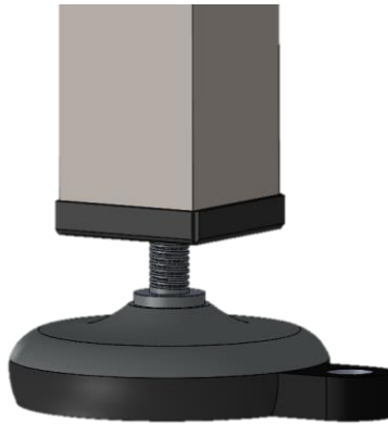
Figura 4-37. Dibujo CAD que muestra el ensamble de perfiles estructurales con tapas y niveladores.
