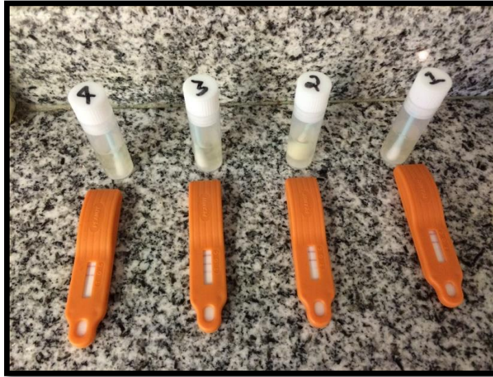
Figura 3. Resultados del Análisis Cualitativo en Superficies de la Bañadora 2 para Cacahuete en Milch Avellana
