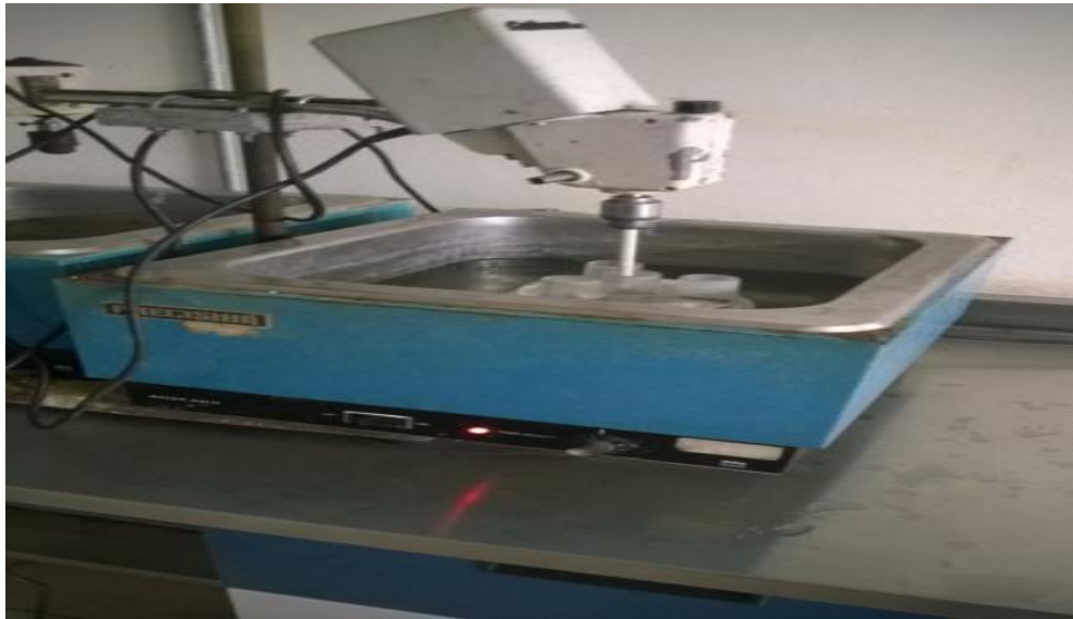
Figura 2.2 Reactor con agitación y calentamiento mediante baño térmico
