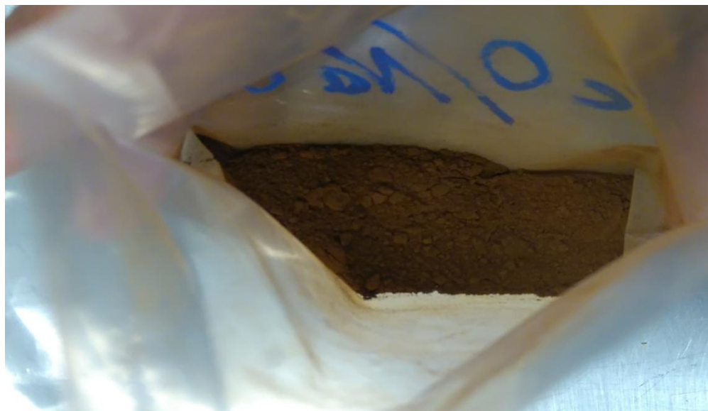
Figura 3.5 Polvos obtenidos a partir de la precipitación con NaOH del licor concentrado.
