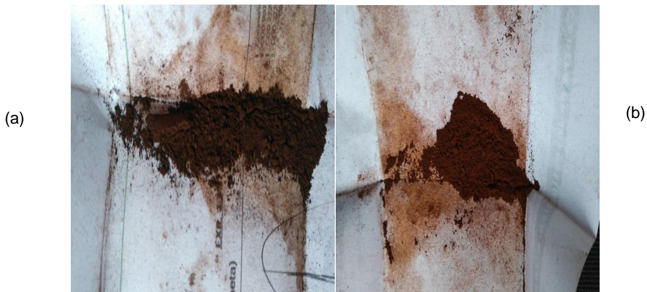
Figura 3.3 Precipitado formado con \text{NaOH} filtrado, seco y molido. a) Sin tratamiento térmico. b) Con tratamiento térmico.
