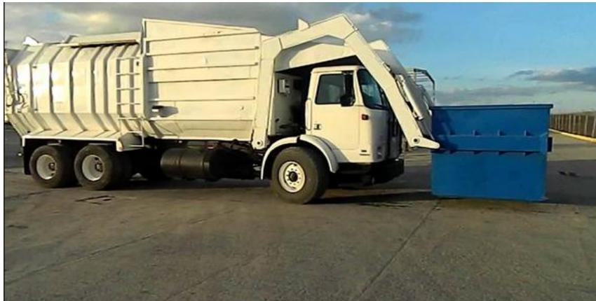
*Figura 3.3.* Camión con sistema de carga frontal. Fuente Google
