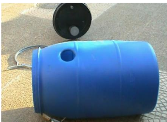
Figura 3.6 Cortes a realizar en el tambo
