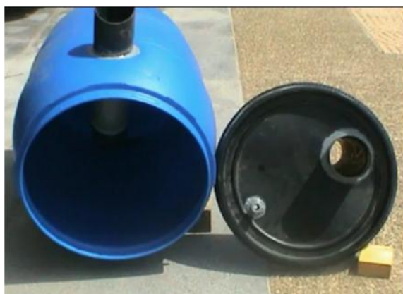
Figura 3.8 Interior del biodigestor para tubería de salida del efluente
