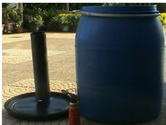
Figura 3.7 Se muestra como hacer el orificio para la tapa sanitaria (alimentación) y de agitador
