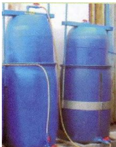
Figura 3.11 Montaje de depósito flotante de biogas
