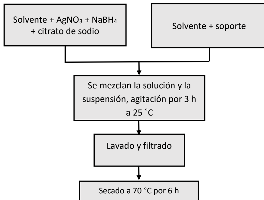
Figura II.6 Método de impregnación para la síntesis de las nanopartículas de Ag soportadas.
