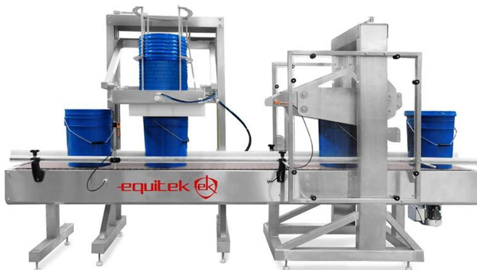
*Figura 39 Tapadora de presión automática, para cubetas de plástico
