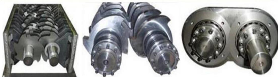
Figura 36 Cuchillas trituradora
