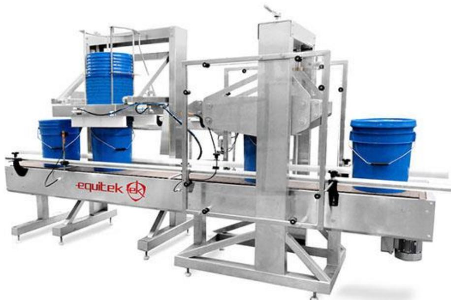
*Figura 40 Tapadora de presión automática, para cubetas de plástico
