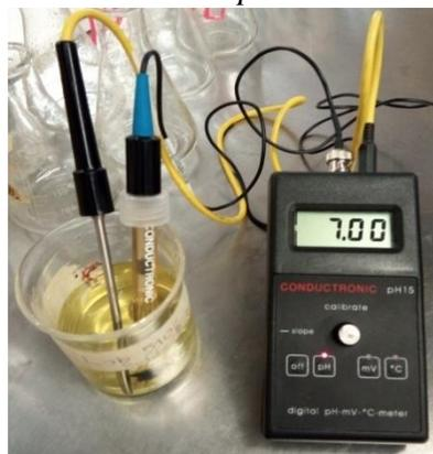
*Figura 4.20 Calibración del potenciómetro*
