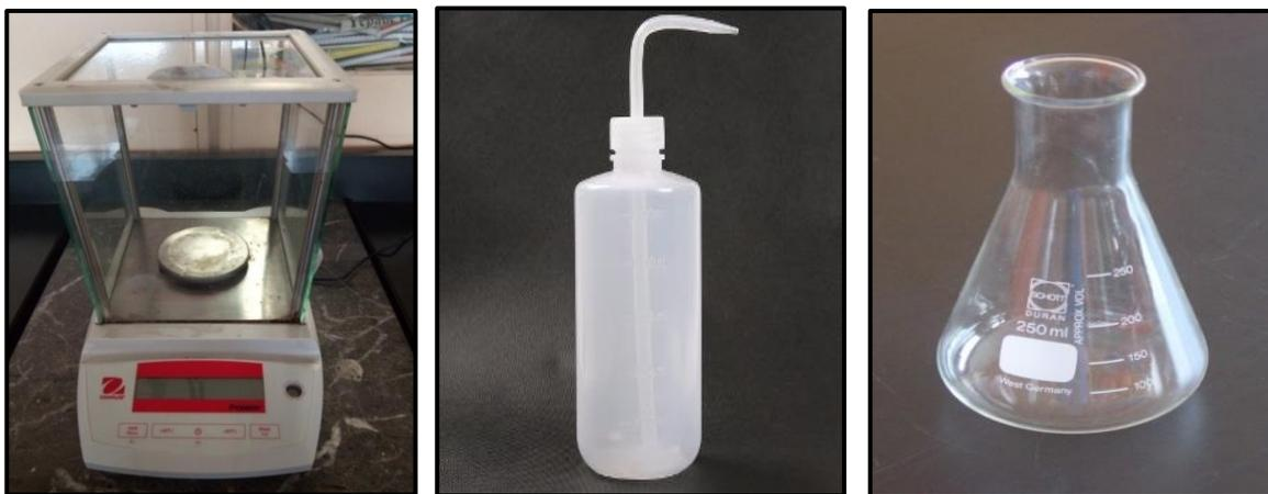
Figura 4.49 Material utilizado en la determinación de cloruros
