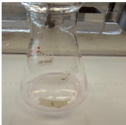
*Figura 4.38 Muestra de agua titulada con ácido clorhídrico*
