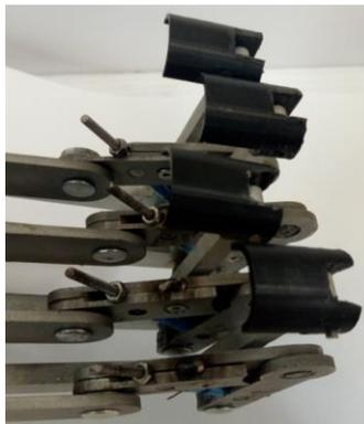
Figura 6.10 Impresión 3D de la interfaz mecánica
