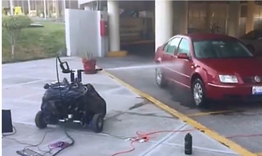
Figura 4.43. Prueba preliminar del sistema con limpieza a alta presión.
