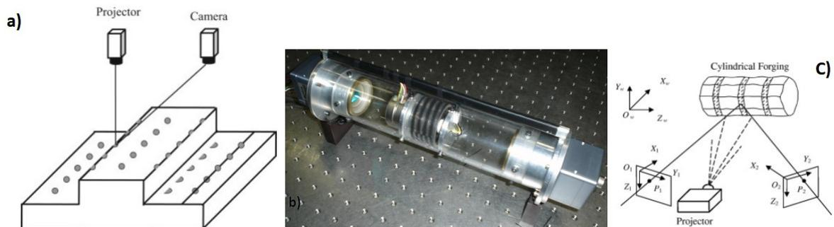
Figura 2.2: Sistema de inspección de luz estructurada: a) [33], b) proyección de franjas [35], c) proyección de un patrón de luz circular [34]
