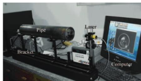
Figura 2.20: Esquema del sistema de visión [58]
