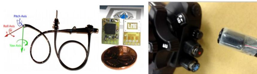
Figura 2.17: Endoscopios con sensores inerciales [52],[54]
