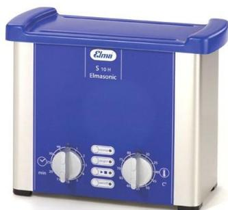
Figure 11. Tina de baño ultrasónico marca Elmasonic modelo S10H.
