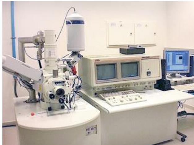
*Figura 13. Microscopio Electrónico de Barrido marca JEOL modelo JSM6300.*
