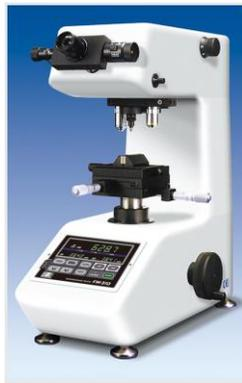
*Figura 15. Durómetro marca Future Tech modelo F-810.*
