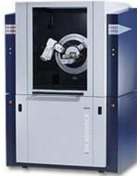
*Figure 14. Difractómetro marca Bruker modelo D8 Advance.*
