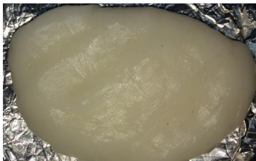
Figura. III.15 Curado de lámina posterior a 7 horas.
