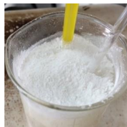
Figura. III.12 Incorporación de Almidón y agua a la mezcla.
