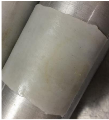
Figura. III.16 Lámina elaborada en rodillos lista para terminar curado.
