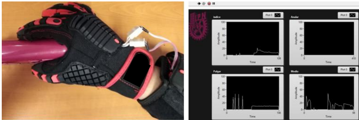
Figura 4.2. Prueba del sistema de sensado generando una pinza trípode.
