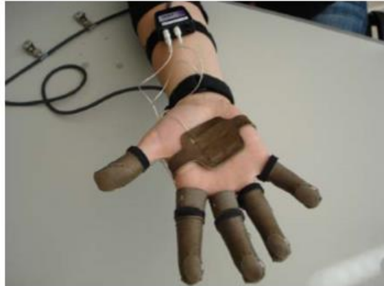
Figura 1.5. Dispositivo medidor de fuerza Finger TPS (Pérez González, Jurado Tovar, & Sancho Bru, 2012).
