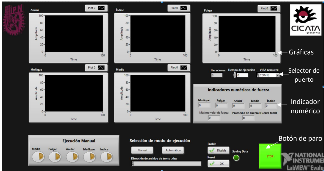
Figura 3.9. Diseño de interfaz de usuario en LabVIEW.
