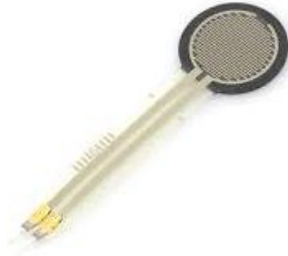
Figura 3.2. Sensor de efecto piezoresistivo para medición de fuerza (Sparkfun Electronics, s.f.).
