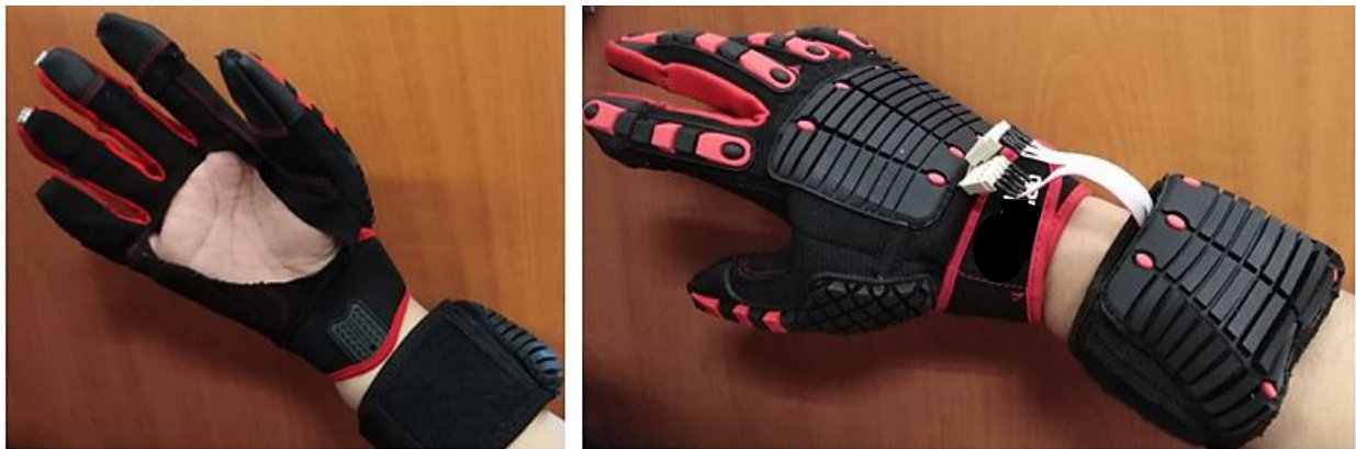
Figura 4.1. Sistema de sensado con retorno acústico construido.
