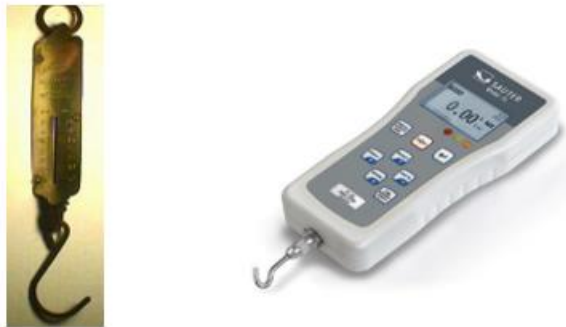
Figura 1.3. Mostrando: a) Dinamómetro analógico, b) Dinamómetro digital (SAUTER SPAIN, s.f.).
