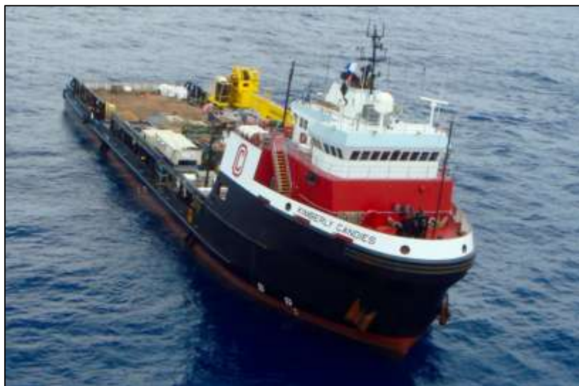
Figura 5.2. Barco de suministro de lodo.
