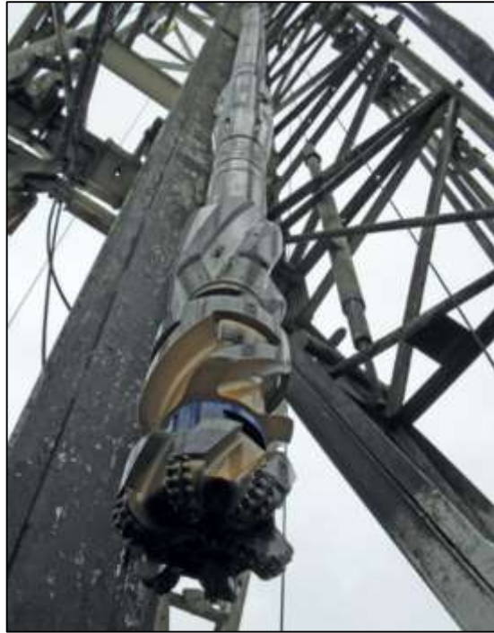
Figura 5.1. Motor de fondo con MWD.
