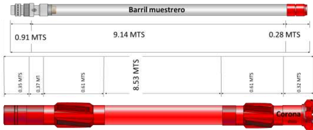
Figura 4.4. Dimensiones de barril muestrero y corona.
