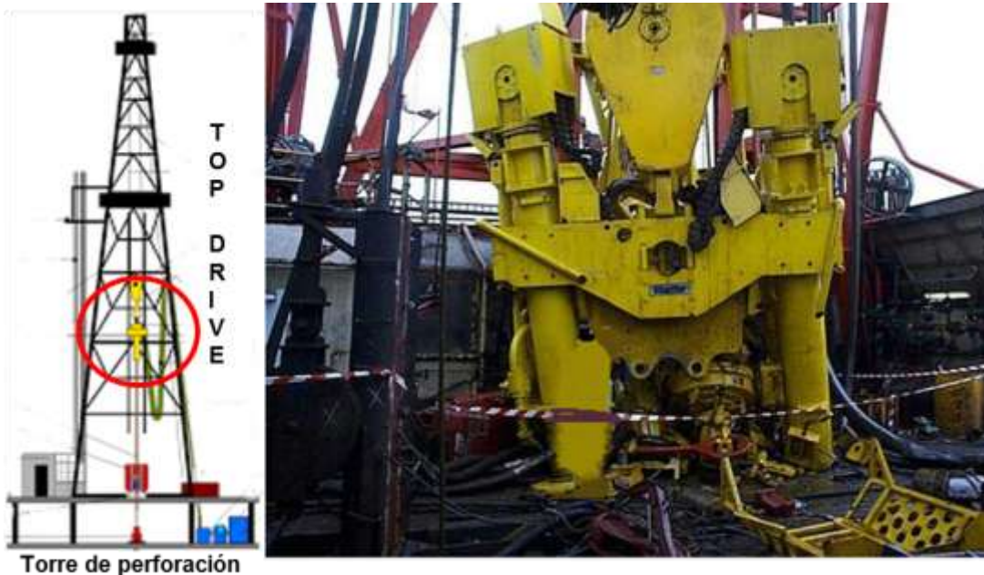
Figura 4.15. Top Drive dañado por golpe de sarta al tratar de liberarla.
