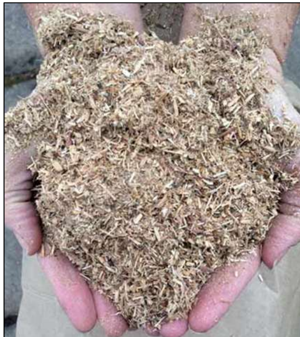
Figura 5.4. Obturante de formaciones a base de celulosa.
