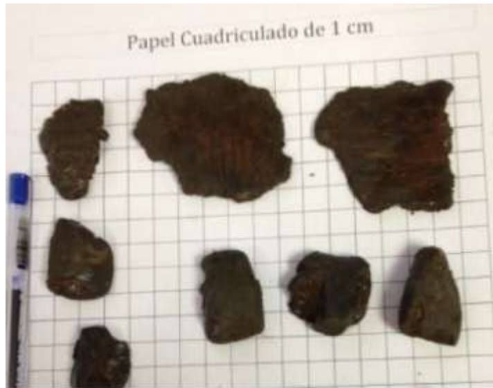
Figura 4.6. Derrumbes de las paredes del pozo.
