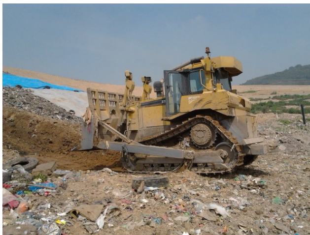
Figura 22. Compactación de los residuos a través de Tractor D-7, compactador 8-16 y Trascabo 953. Año: 2012
