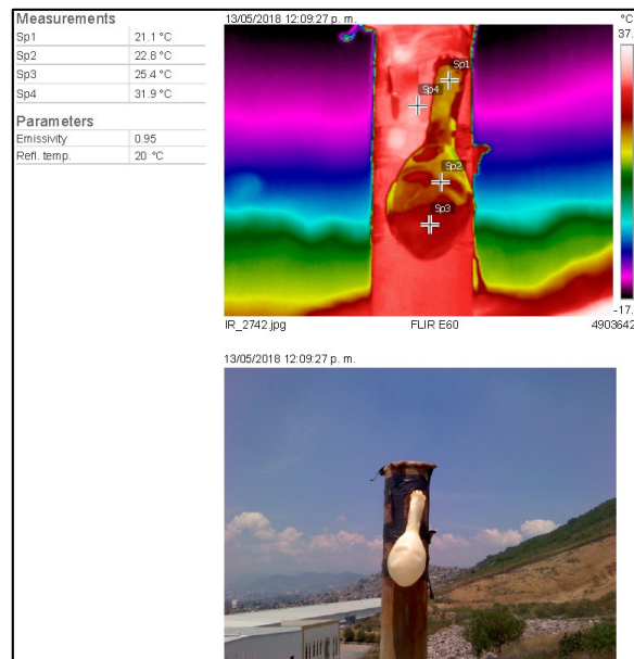
Figura 72. Temperatura de la muestra de biogás (interior del globo): 21° C a 25° C
