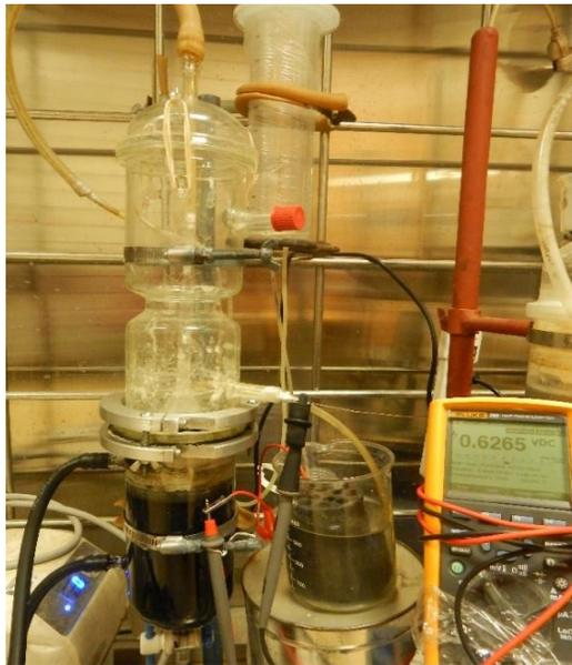
**Figura 6.4** Fotografía del reactor UASB-celda.
