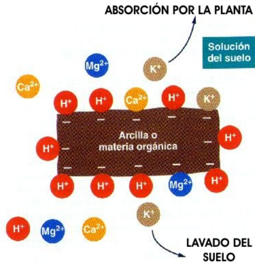
Figura 5. Representación de la atracción eléctrica entre el suelo y los cationes de H^+ , Ca^{2+} , K^+ y Mg^{2+} .
