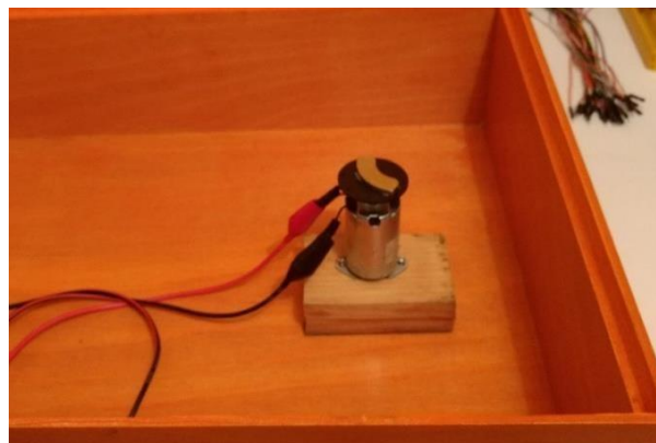
Figura 4.6 Montado del motor del sistema de agitación.
