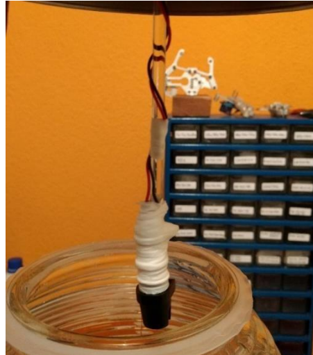
Figura 3.13 Adaptación para la lectura del sensor.
