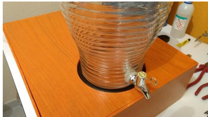
Figura 3.38 Colocación del contenedor en la base.
