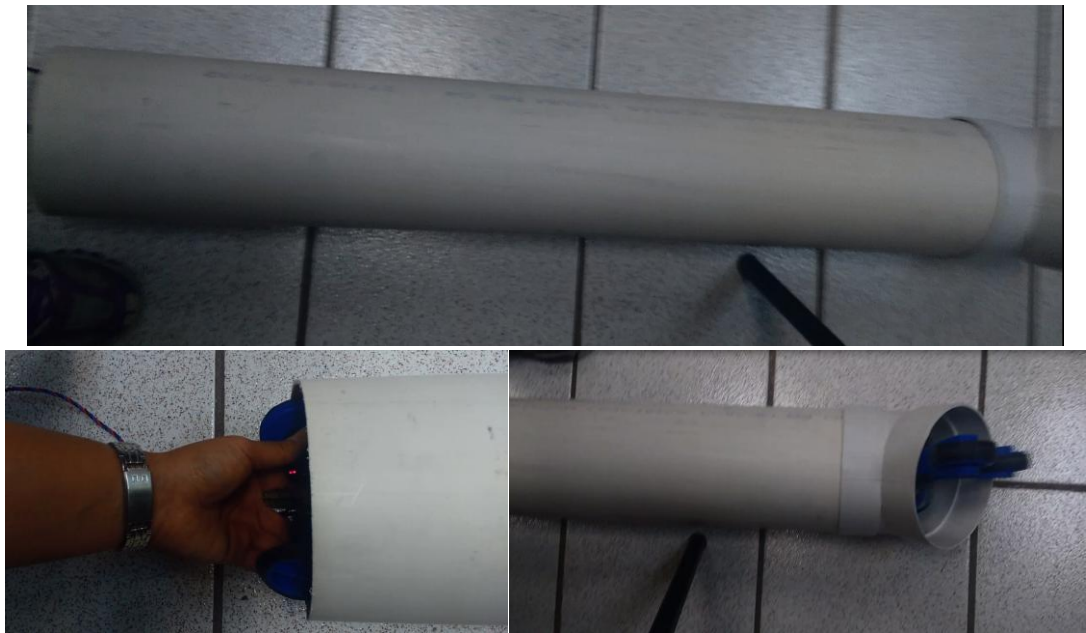
Figura 78. Prueba de desplazamiento en tubería horizontal.
