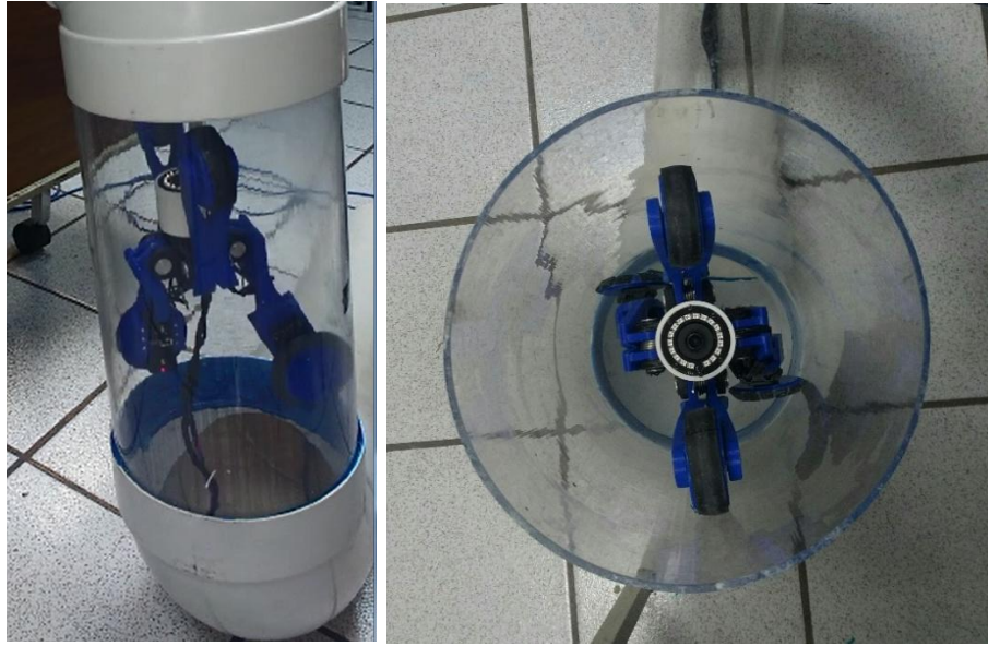
Figura 79. Prueba de desplazamiento en tubería vertical.
