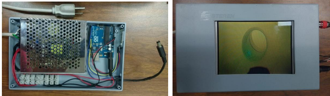
Figura 59. Construcción de caja de control.
