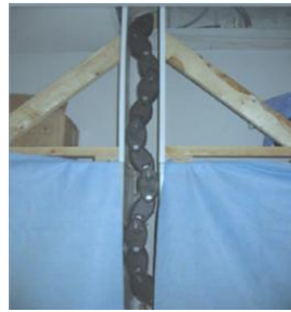
Figura 11. Robot tipo serpiente en tubería vertical.
