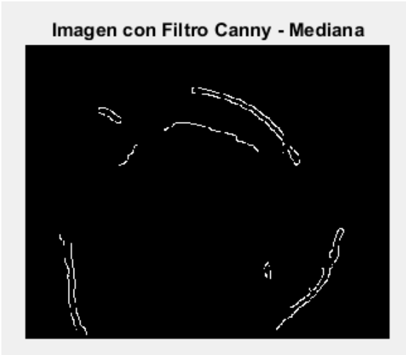
Figura 86. Imagen con filtros: Mediana y Canny para identificación de marcas (rupturas) en las paredes de la tubería.
