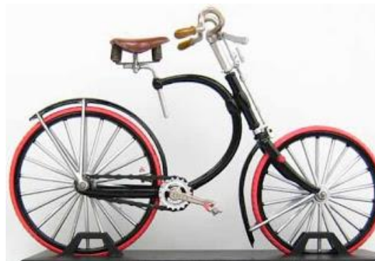
Figura 1. 3 Modelo "Safety Bicycle" de 1885 creado por John Kemp Starley
