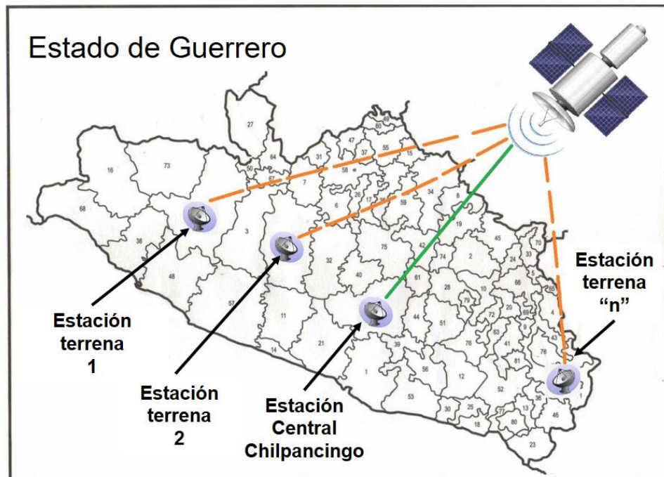
Figura 4.9 - Ubicación de las estaciones terrenas y HUB de la red de comunicaciones en Guerrero
