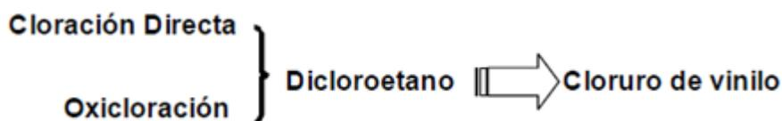
Figura 2.2 Reacción para la formación de Cloruro de Vinilo.
