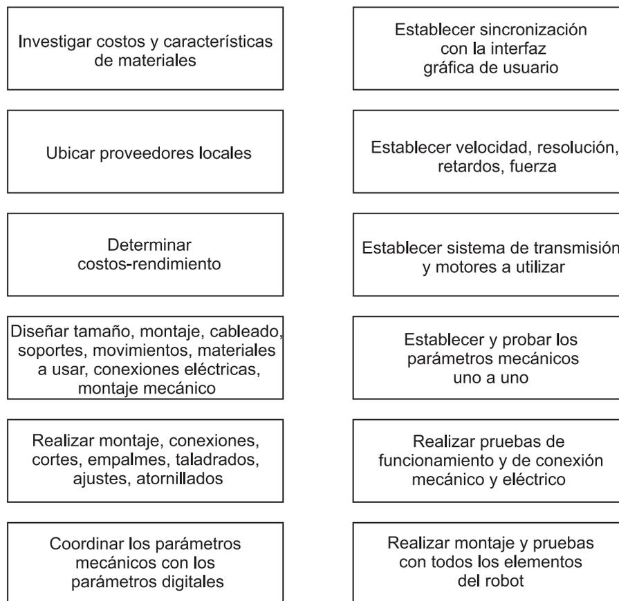
Figura 3.14: Pasos para desarrollar los elementos mecánicos del robot cartesiano (Elaboración propia, 2019)
