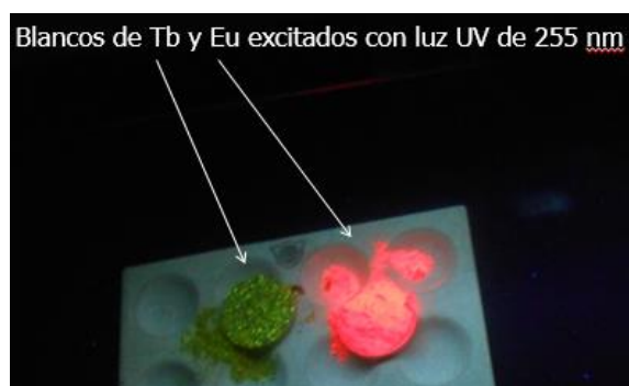
Fig. 2.8. Blancos dopados con terbio y europio iluminados con luz UV de 255 nm.
